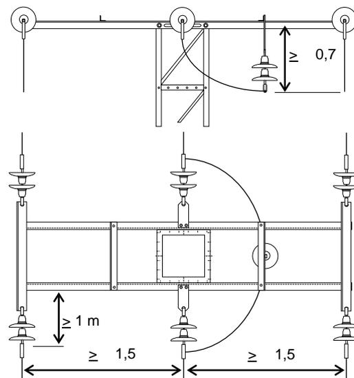
La configuración adoptada en las crucetas rectas, para el caso de ser utilizadas en apoyos de alineación, ángulo o anclaje, permite que el paso de la fase central sea realizado a cota inferior a la propia cruceta y por supuesto manteniendo la distancia de 600 mm.
