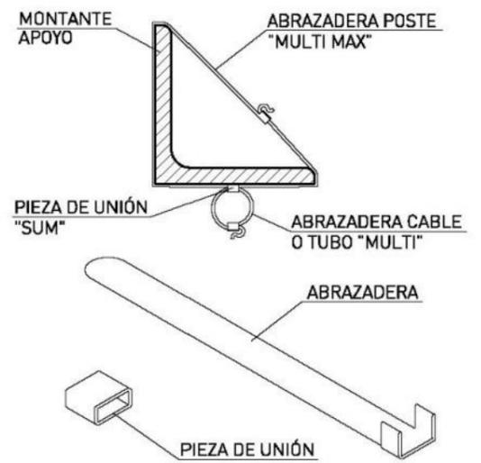
**DETALLE ABRAZADERAS TIPO H-6 PARA BAJADA CABLES/TUBOS SIN ESCALA**
