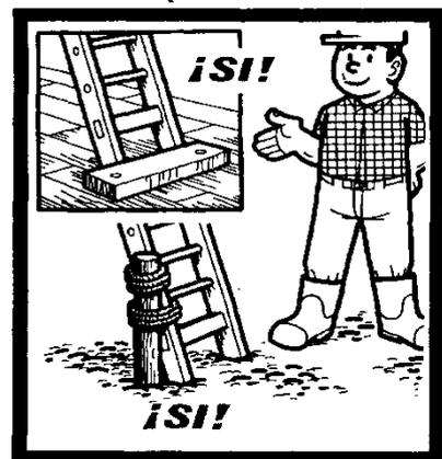
Instalar las escaleras sobre un suelo estable, contra una superficie sólida y fija, y de forma que no puedan resbalar, ni bascular.
