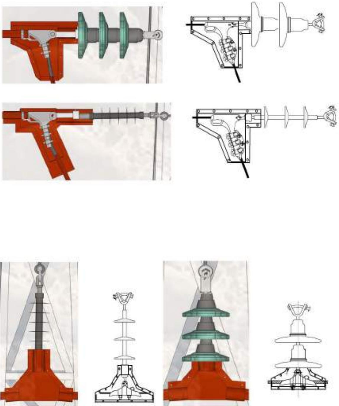
Figura 6d: Montaje de forros sobre cadenas de amarre y suspensión
