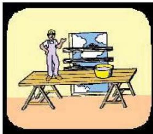
En trabajos en interiores cerca de huecos en las paredes de cerramiento, se podrá proteger estos huecos mediante una serie de tablonces colocados horizontalmente.
