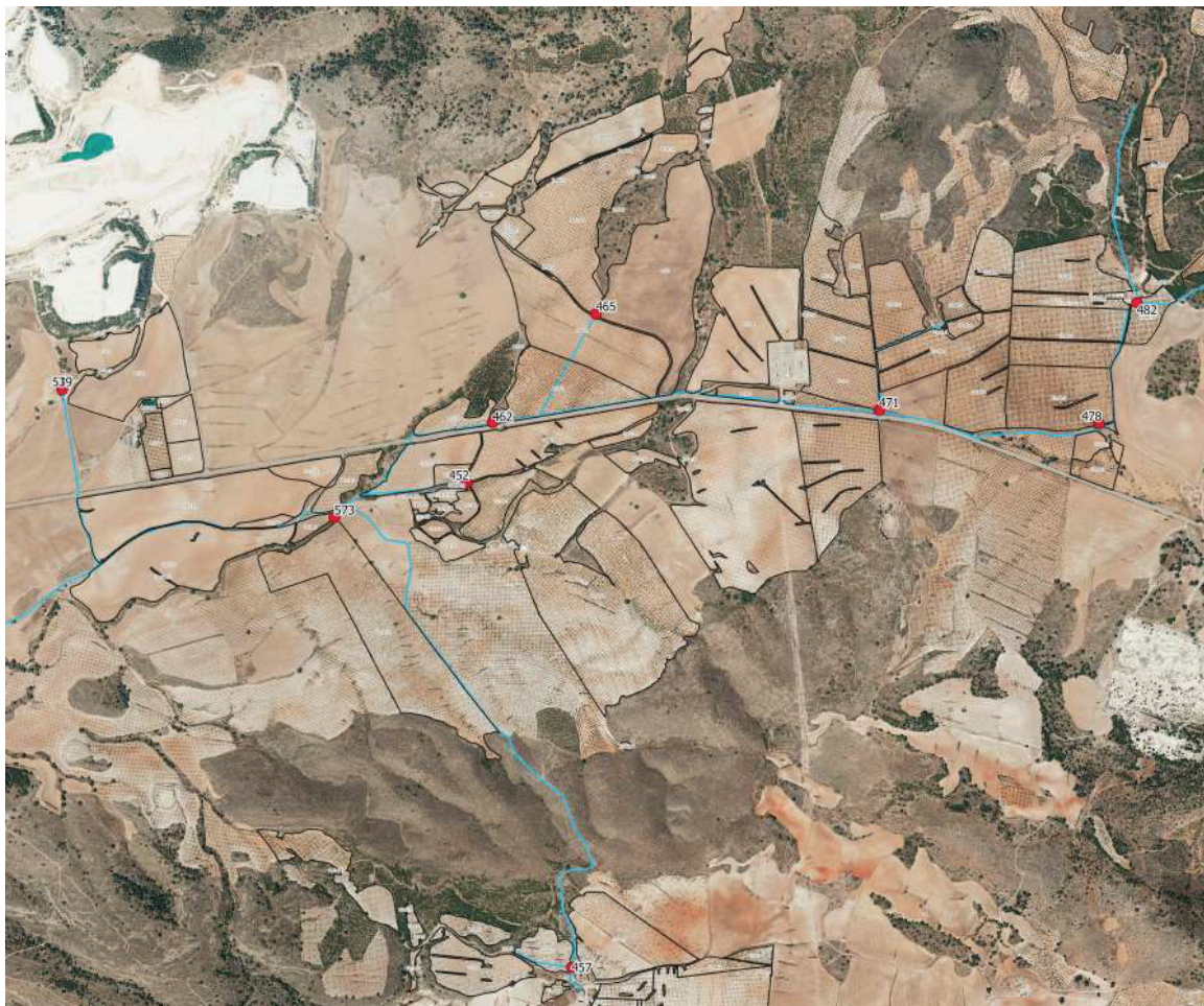
Ilustración 16- Distribución de hidrantes. (Fuente: Elaboración propia)
