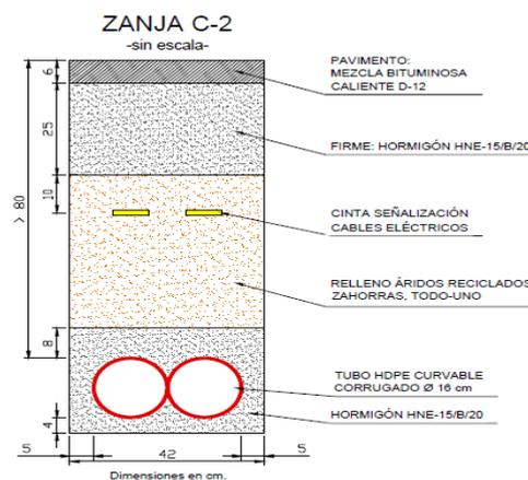
**CANALIZACIÓN ENTUBADA 4 TUBOS DISPOSICIÓN HORIZONTAL CALZADA**
