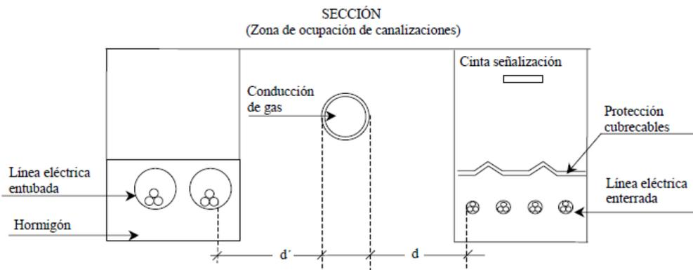
La distancia mínima entre los empalmes de los cables de energía eléctrica y las juntas de las canalizaciones de gas será de 1 m.
