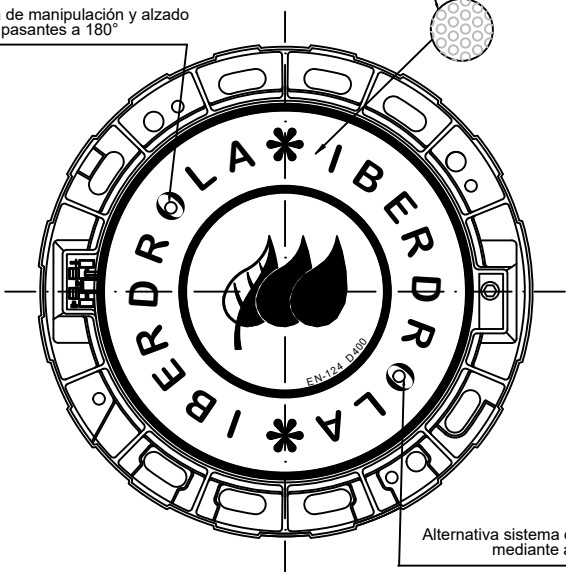
DETALLE MARCO M3 Y TAPA T3 Escala 1:10
