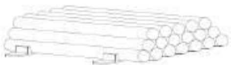
APAREJO DE ACOPIOS DE TUBERIAS
