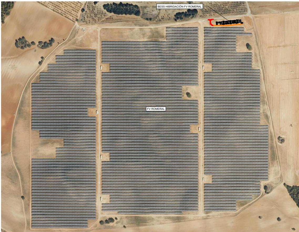
Figura 4 Implantación Sistema de Almacenamiento y Planta Fotovoltaica
