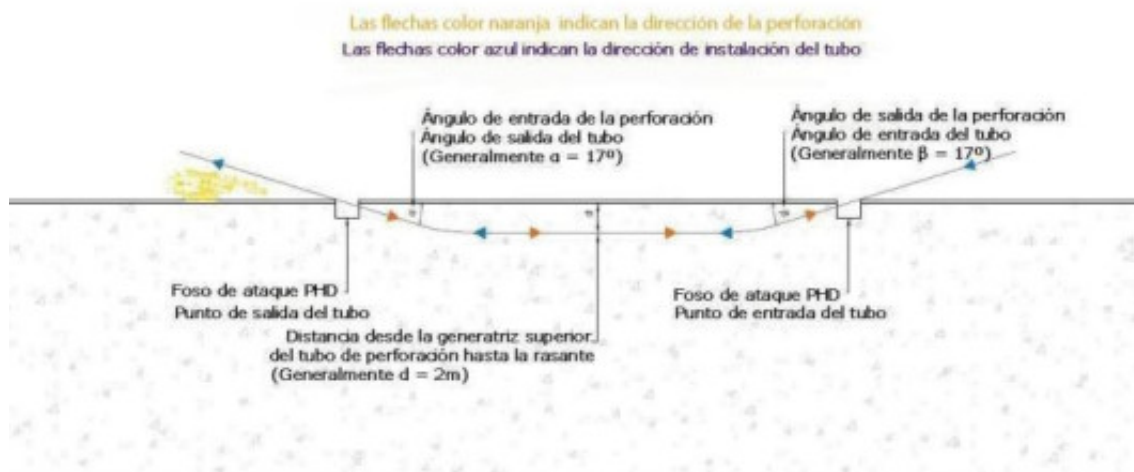
Figura 4. Esquema de perforación e instalación del tubo en el cruzamiento
