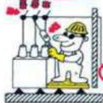
3. Verificar la ausencia de tensión.
