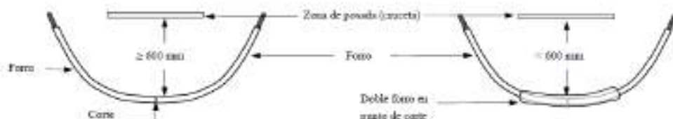
Figura 5b: Instalación cubiertas en puentes
